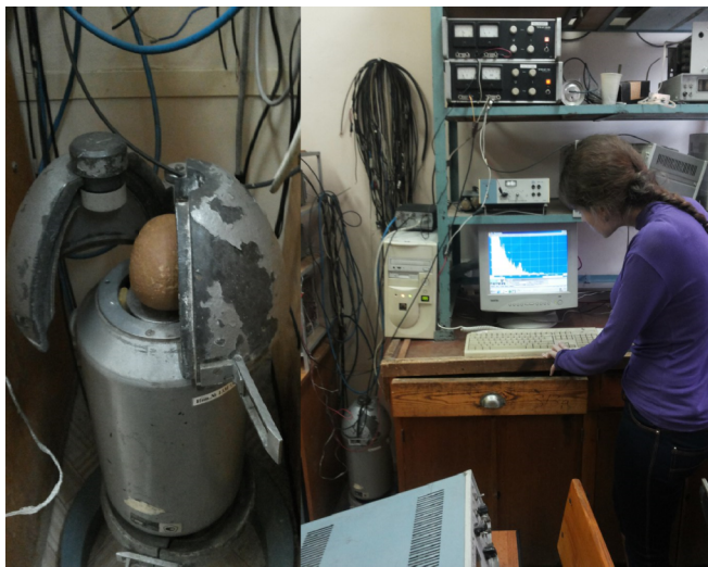
Рис. 5. Обработка энергетических спектров источников излучений вулканической бомбы
