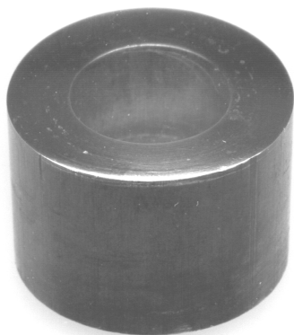
Рис. 7. Фото детали «заглушка», полученной из пористой медной заготовки
