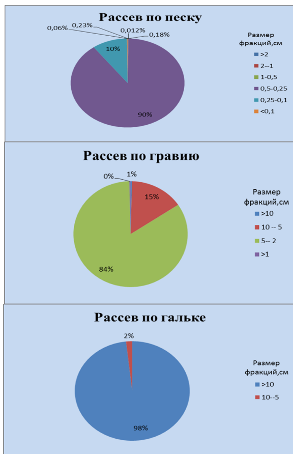
Рис. 2. Результаты ситового анализа проб терригенных наносов
