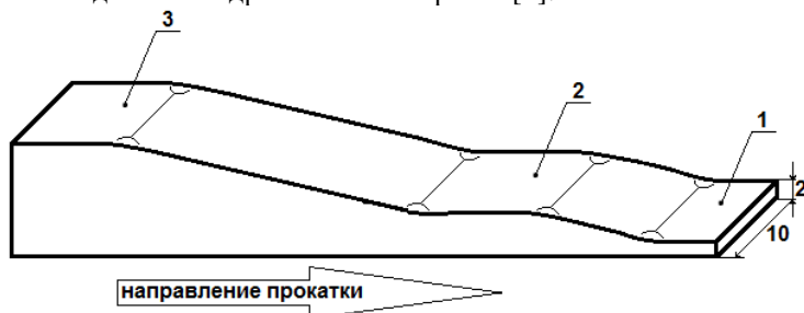
Рис. 1. Исходный образец для прокатки с варьированием степени обжатия по длине раската: 1 – 65%, 2 – 20%, 3- 0%
