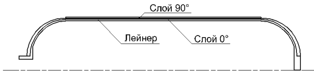
Рис. 3. Функционально-ориентированные слои малогабаритного корпуса
