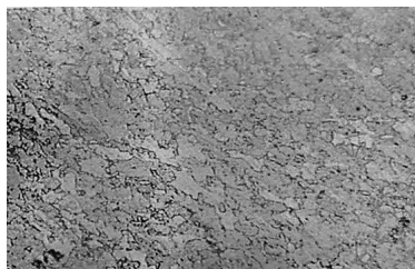
Рис. 2. Микроструктура порошкового материала на основе Ag и лигатуры Ni (×200)
