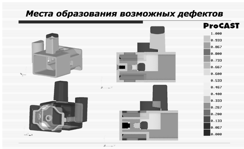
Рис. 6. Места образования возможных дефектов
